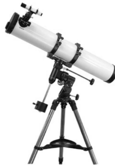
В комплекте идет экваториальная монтировка EQ с червячными приводами по обоим осям и с высококачественными мягкими тросиками тонких перемещений на алюминиевой треноге. Окуляры просветленные Супер Кельнер с посадочным диаметром 1.25", f=6мм и f=20мм, Увеличения соответственно 120х и 35х. Телескоп комплектуется искателем в кольцах 5х24.
